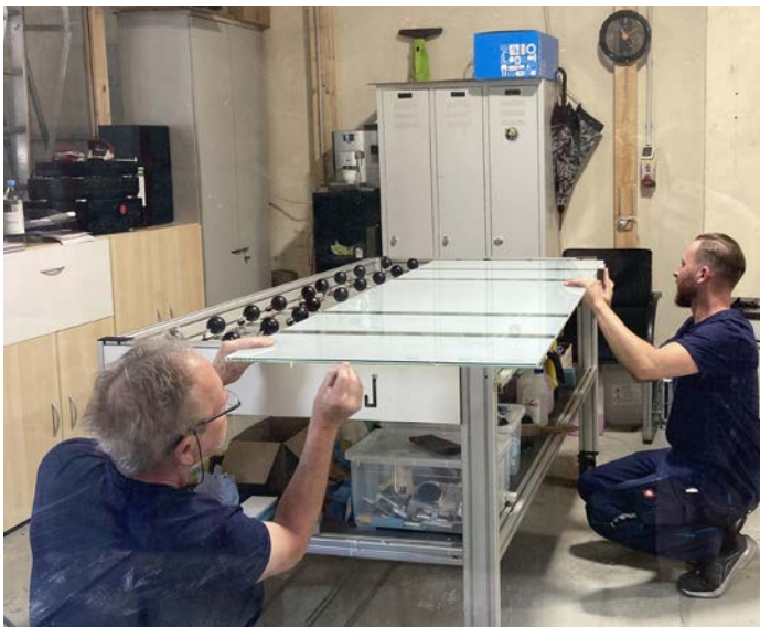
Ein Blick in die VSG-Fertigung: Hier wird Hand angelegt, um die Kanten zu glätten.
